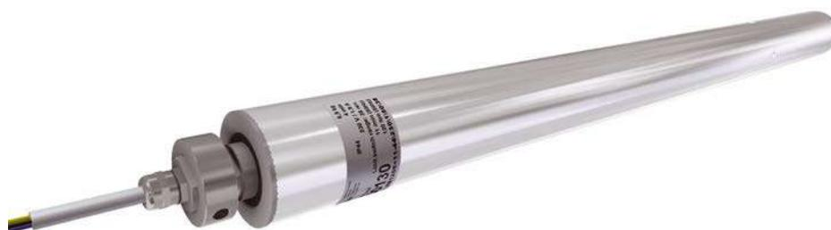
Le moteur tubulaire Ridder RB120E<sup>plus</sup>, sans entretien, est un entraînement destiné à entraîner des systèmes de stores à enrouleur dans les serres et des étales. Le moteur tubulaire est intégré, de série, dans un tube en aluminium de 63 mm de diamètre (épaisseur 1,5 mm) et est destiné aux tubes enrouleurs de 63 mm. De par son intégration, le moteur tubulaire peut être entièrement rembobiné.
