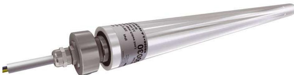
Le moteur tubulaire Ridder RB50E<sup>plus</sup>, sans entretien, est un entraînement destiné à entraîner des systèmes de stores à enrouleur dans les serres et des étales. Le moteur tubulaire est intégré, de série, dans un tube en aluminium de 50 mm de diamètre (épaisseur 1,5 mm) et est destiné aux tubes enrouleurs de 50 mm. De par son intégration, le moteur tubulaire peut être entièrement reboîné.
